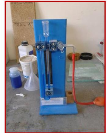
**L'aggiunta di TiO<sub>2</sub> all'interno del legante comporta un incremento della finezza ed una diminuzione della lavorabilità**
