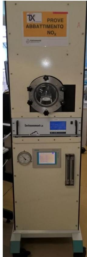
Sistema di misura indice di abbattimento fotocatalitico (Ac%) c/o ITC
