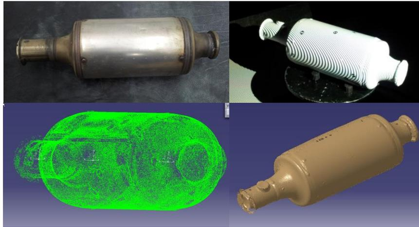
Attraverso tecniche avanzate nel rilievo dal reale di superfici 3D si è ottenuta la geometria del catalizzatore utilizzata per le simulazioni CFD.
