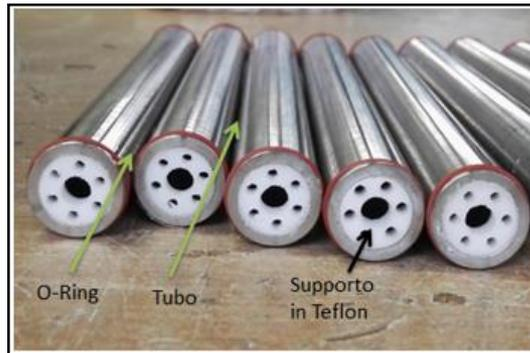
Il reattore è realizzato in acciaio inox AISI 304 ed è composto da:
